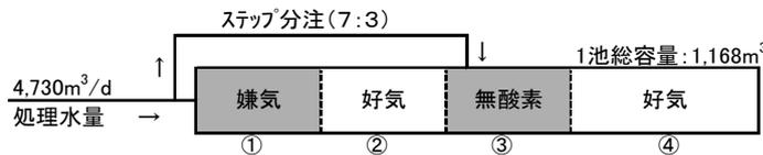
II 系 × 2池 (ステップ流入硝化内生脱窒法)
